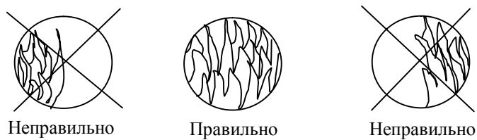
Рис. 3. Расположение датчика относительно пламени и вид на пламя через визирную трубу.
